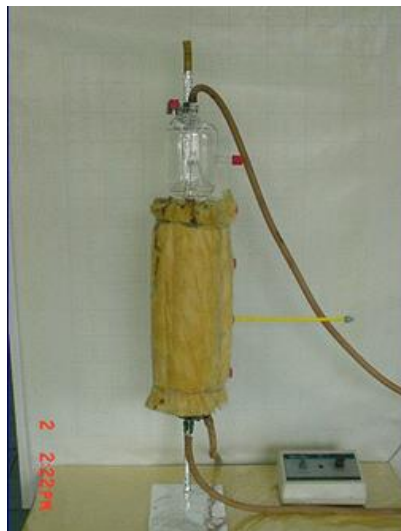
Figuras 1a,b,c. Construcción de los reactores anaerobios para condiciones termofílicas V .
