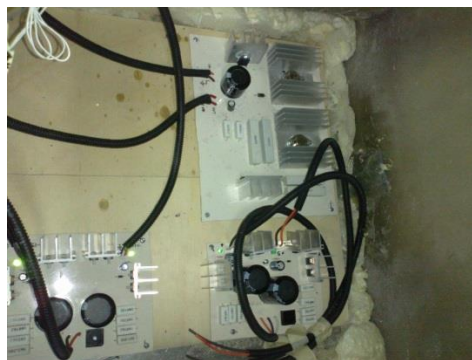
Figura 3. Fuentes de voltaje simétricas de \pm 5V , \pm 15V y de \pm 30V
