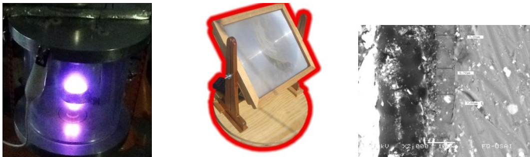
Figura 11.- (a) Cámara para la nitruración iónica de una fundición nodular (b) Prototipo de concentrador solar tipo Fresnel de construcción propia y (c) Imagen de MEB de recubrimiento sol gel sobre una aleación de aluminio,
